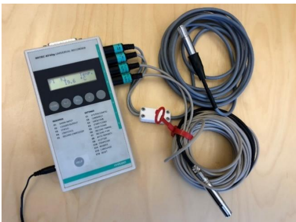
Figur 29. Mitec AT40g med fukt- och temperaturgivare Vaisala HMP60 och HMP50
