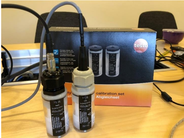
Figur 39. Kontroll av fuktgivare i saltlösning med 11,3 % RF och 75,3 % RF.
