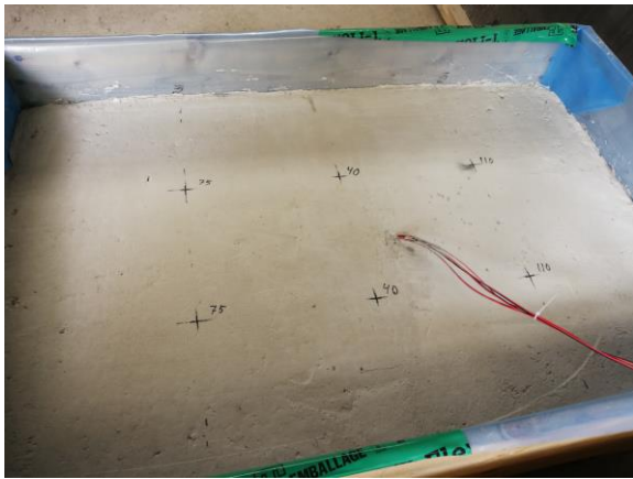
Placering av borrhål markeras ut.
