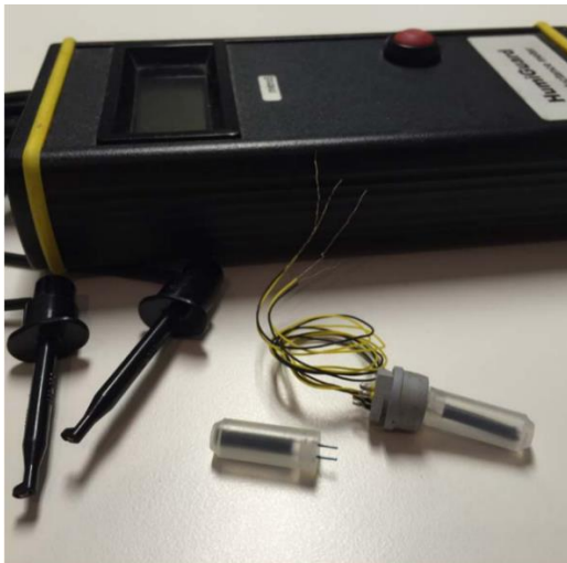
Figur 27. Mätinstrument och givare för HumiGuard (SBUF 2014)
