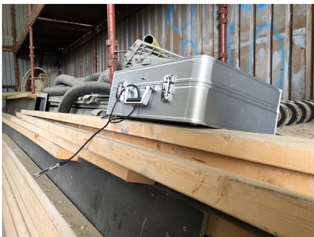
Figur 37. Temperatur- och fuktgivare ovanför betongprover i utomhusmiljö.
