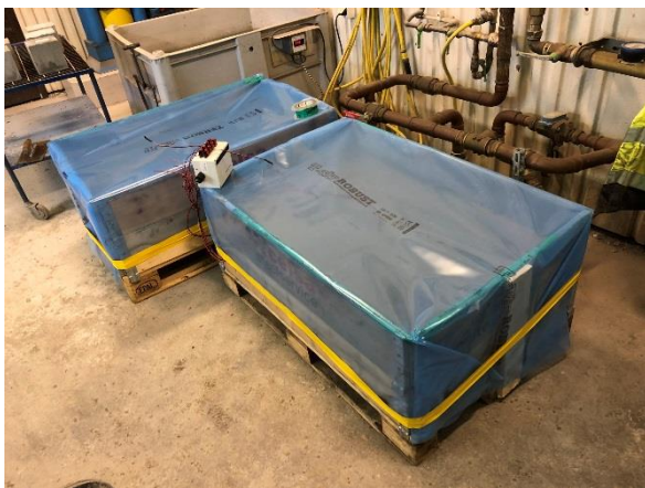
Proverna plastas in med diffusientät plast.
