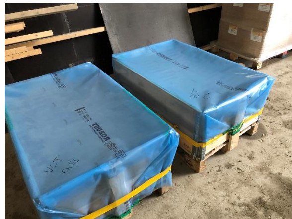
Proverna plastas in med diffusionstät plast.
