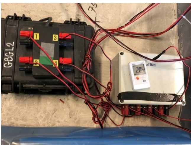
Figur 41. Testo 177-T4 t.v. och BetongDatorn t.h.
